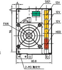
※コネクタピンサイン詳細図 pNSP2U-1000P-AAS(12V)
